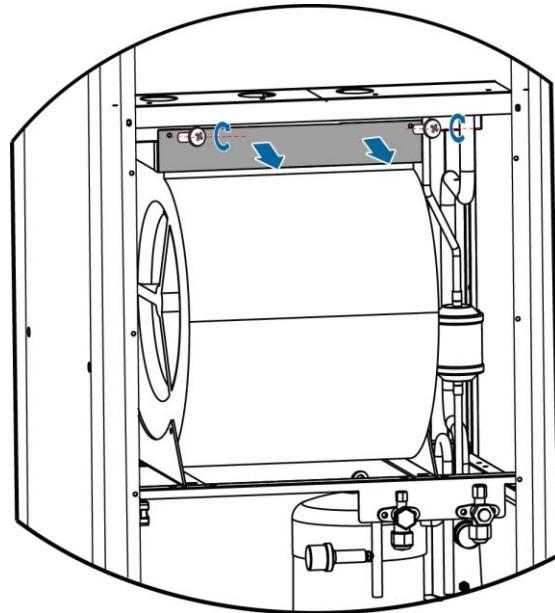
步骤 5 将风机支架四角上的螺钉取下，并向前将风机拖出，如图 5-2 所示。
