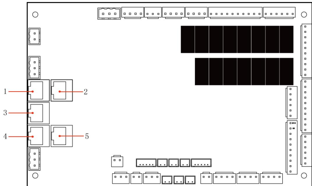
1: 通信口 1      2: 通信口 2      3: 通信口 3      4: 通信口 4      5: 通信口 5
