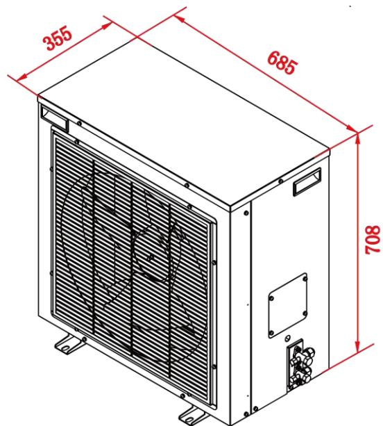
图2-4 标准室外机 AMD12 结构示意图（单位mm）
