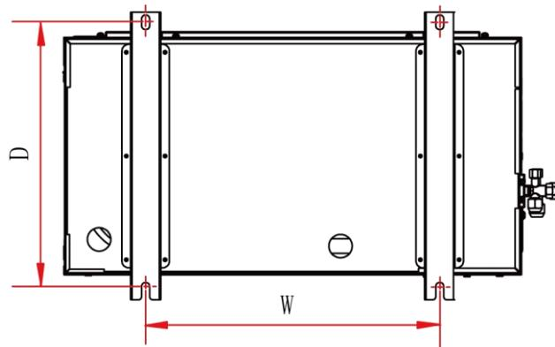
图 2-20 中室外机支架对地安装孔尺寸如表 2-3 所示
