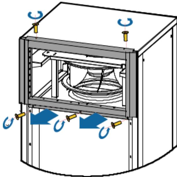
步骤 1 将风机支架四角上的螺钉取下，并向前将风机拖出，如图 5-4 所示。
