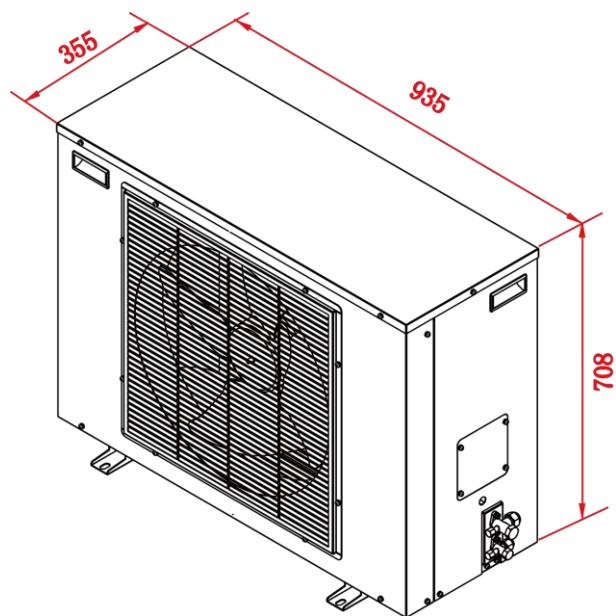
图2-5 标准室外机 AMD19 结构示意图 (单位mm)
