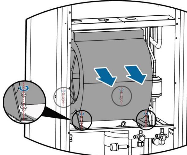
步骤 6 维护完之后请按照相反步骤重新将室内风机安装到位。
