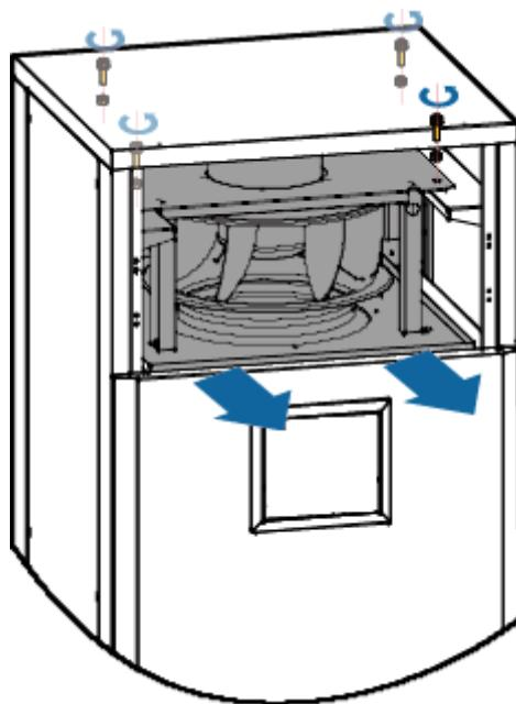
步骤 2 维护完之后请按照相反步骤重新将室内风机安装到位。
