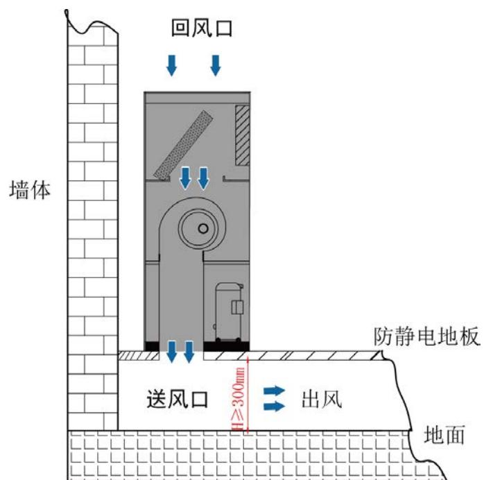
图2-12 顶送风机组安装空间示意图（直连风机）
