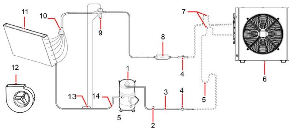
(1) 压缩机      (2) 高压开关      (3) 排气管      (4) 截止阀
