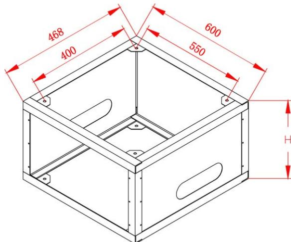
图A-2 AM8/AM9/AM13 机组支架尺寸图示（单位：mm）
